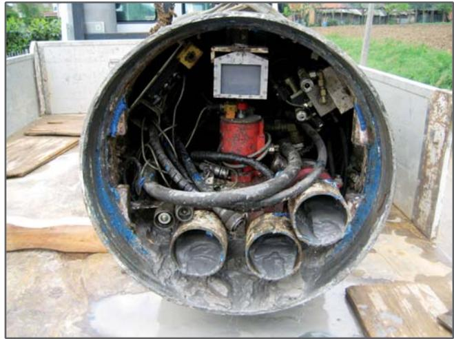
Fig. 8 - Particolare retro della testa con target e impianto di smarino
