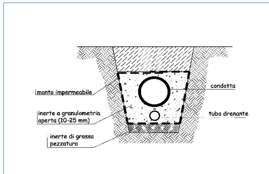
Figura 23 - Sistema di protezione della falda.
