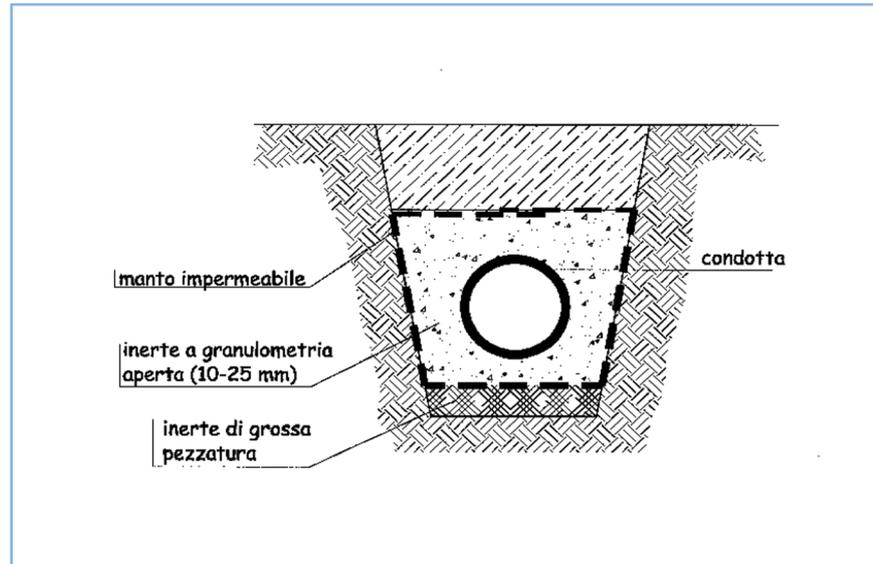
Figura 22 - Sistema di protezione della falda.
