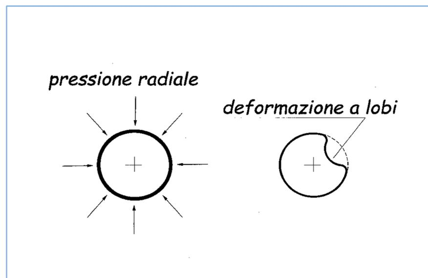
Figura 20 - Pressione radiale e Deformazione a lobi.
