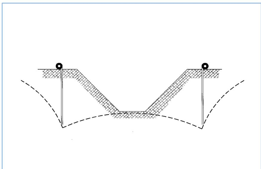
Figura 19 - Drenaggio con sistema Well-Point.
