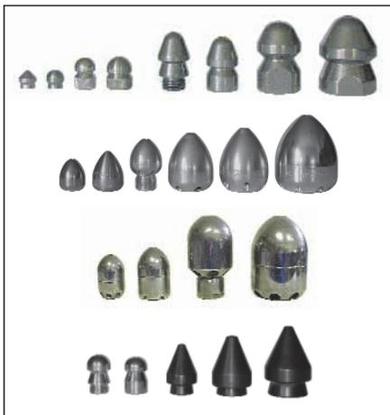
2. ugelli di sfondamento (triangoli; bombe): comunemente utilizzati per pulire fognature di grosso diametro. Il peso dell'ugello assicura che esso rimanga sul fondo pur con elevate portate e li rende particolarmente efficaci per rimuovere fanghi. I getti a ventaglio (=taglianti) possono anche essere aggiunti nell'ugello a bomba per pulire fognature di diametri maggiori.
