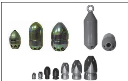
3. ugelli rotanti (catene, eliche, rotanti, rondò): hanno il vantaggio di raggiungere una copertura completa del tubo e sono adatti in modo particolare per depositi di grasso e radici sottili.
