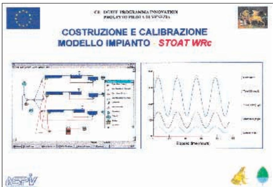
• Figura 8 - Il modello STOAT simula le fasi di trattamento dal punto di vista idraulico e processistico
