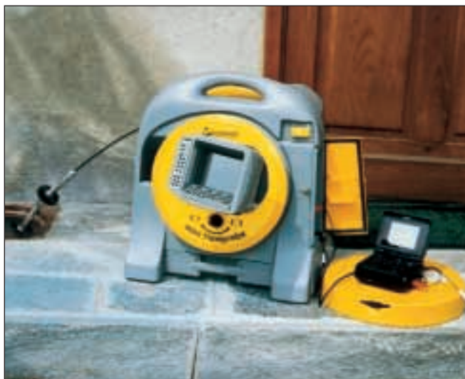
• Figura 5a-5b - Telecamera e videoregistratore "operativi" con testa da 30 mm e display di centratura a spazzole.
