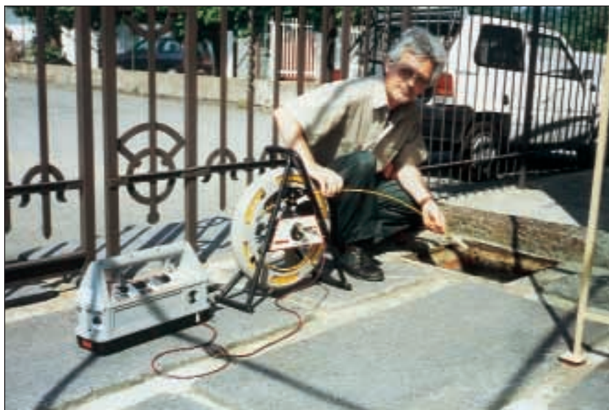
• Figura 1a - Sonda collegata ad asta flessibile rilevabile ed a relativo generatore di segnali.
