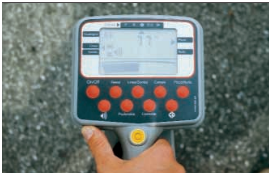
• Figura 4 - Rilevamento automatico della profondità dei servizi.
