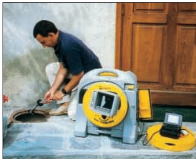
• Figura 5a-5b - Telecamera e videoregistratore "operativi" con testa da 30 mm e display di centratura a spazzole.
