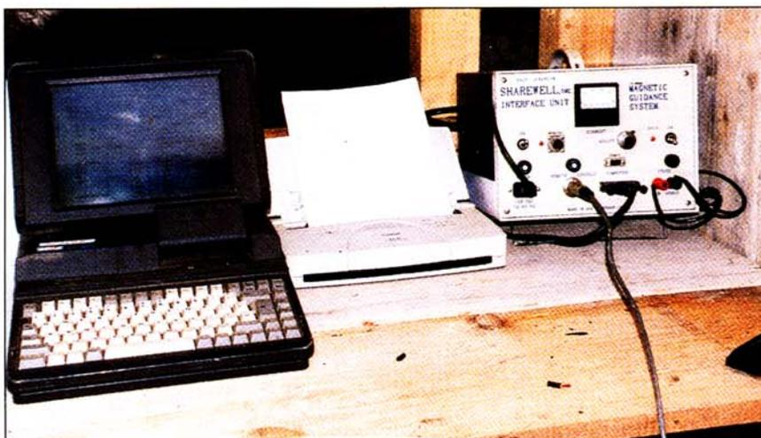
• *Figura 19 - Racines (Bolzano). Elaboratore dei dati circa la profondità, la lunghezza e la distanza dal punto di partenza dello scalpello; il tutto a completamento delle informazioni fornite dalla apparecchiatura della Figura 18.*
