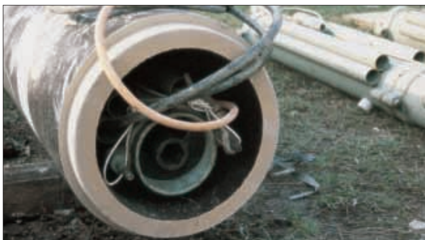
• Figura 8 - Particolare del tubo con coclea intubata e tubazioni di controllo e comando già assemblate.
